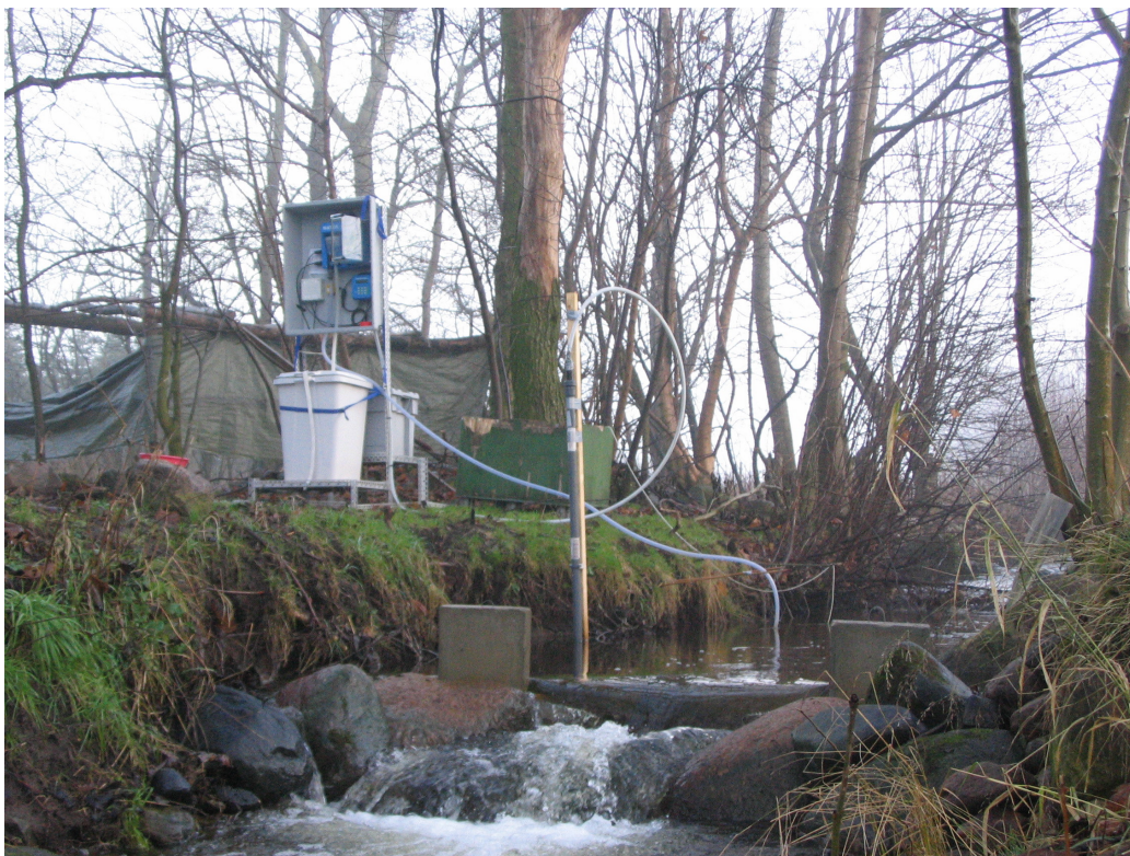
Figur 1. Flödesstyrd provtagare till vänster, med tryck givare (monterad på stående regel). Tidsstyrd provtagare i gröna lådan till höger om den flödesstyrda.
