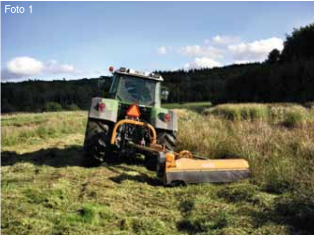
Om slänterna är byggda rejält flacka är det enkelt att slå av vegetationen med en bakmonterad, vinklignsbar slaghack efter vattennivåsänkningen på sensommaren.
