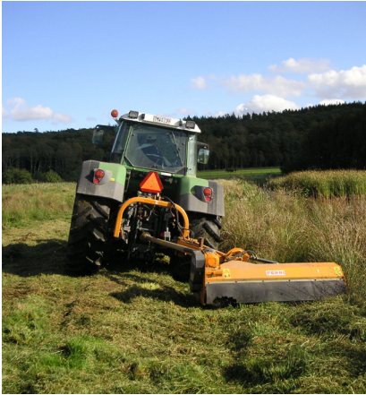
En sidmonterad slätterbalk eller slaghack kan även putsa flacka slänter.
