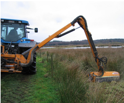
För svåråtkomliga ställen eller branta stränder kan en slaghack monterad på en traktorburen hydraularm.
